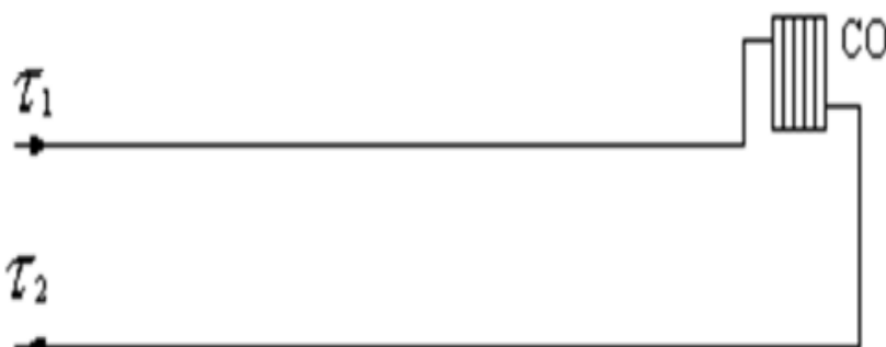
Рисунок 2 – Схема присоединения теплотребляющих установок потребителей к тепловым сетям
